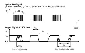
Figure 2. Output Fucntion (mit Jitter)
