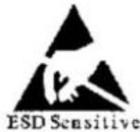
1、车间铺设防静电地板并做好接地, 工作台采用防静电工作台, 带电产品接触低阻值的金属表面时, 由于静电引发产品故障的可能性是很高的, 故要求工作台及与产品相接触之处使用表面电阻为  $10^6-10^9 \Omega$  的桌垫。
