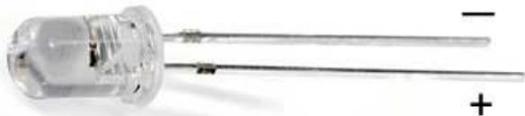
Die Leuchtdioden mit 20mA sind optimal für Modell oder Anzeigen. Die LED immer mit dem passenden Vorwiderstand betreiben. Benutzen Sie die blaue und weisse LED mit 220 Ohm und die restlichen mit 330 Ohm. So ist die Strombelastung des Atmega8 optimal. Die LED muss richtig gepolt werden.
